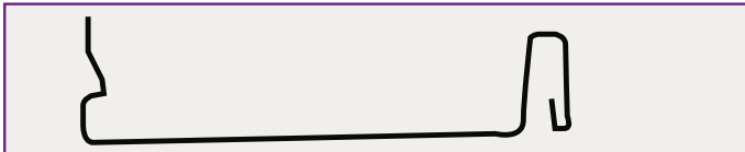
Schnappfalz 25 mm abgeflacht in Österreich 25,40 mm
